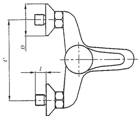
图 A.8 壁式明装单柄双控浴缸/淋浴水嘴
