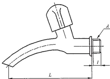
图 A.7 壁式明装单柄单控浴缸水嘴
