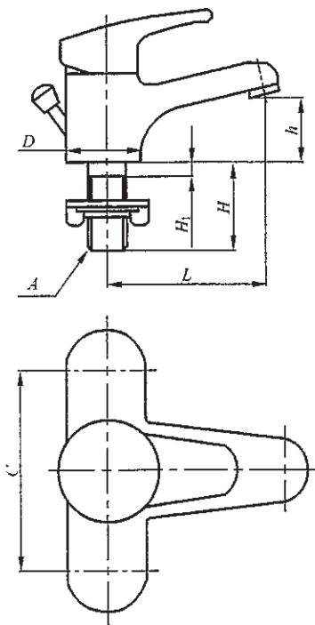
图 A.6 台式明装单柄双控洗面器水嘴(双孔)
